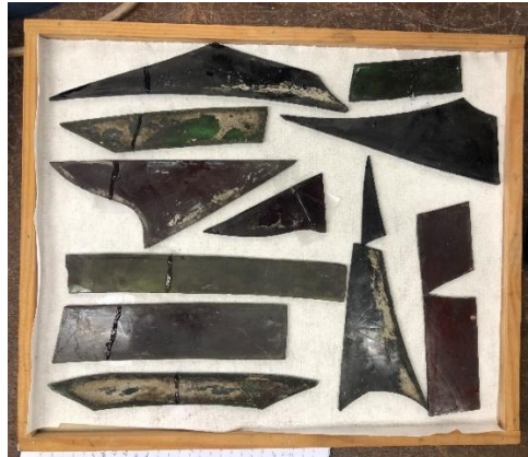
Pièces recollées pour le panneau 46 de la Communion Remarquer les joints de colle, qui seront supprimés après séchage (Les deux pièces en bas à droites ont fait l'objet d'un comblement)
