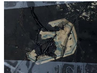
Cette pièce présente de multiples fractures (panneau 39). (l'étiquette, d'origine, a été gardée volontairement)
